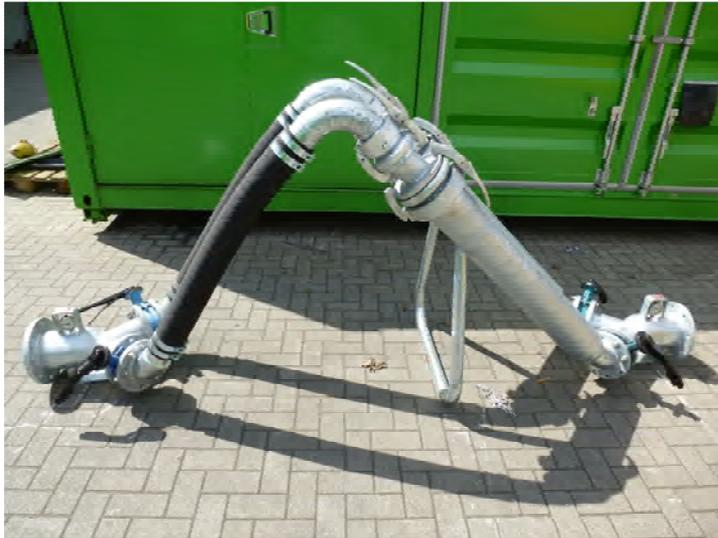
Doppelfiltereinheit zur einfachen Filterung in der Saugseite. Beidseitig mit Flansch DN 150, der nach Kundenwunsch ausgestattet werden kann. Jeder Filter kann einzeln per Butterfly abgeschiebert werden, so dass eine Reinigung während des Betriebes möglich ist.
