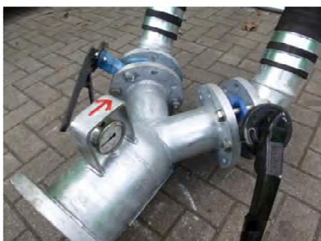
Manometer an Ein-/Ausgang zur einfachen Überprüfung des Differenzdruckes (Verschmutzung)
