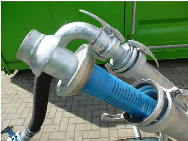
Die Filter können einfach und schnell über Perrot Kupplungen ausgebaut werden, wodurch eine schnelle Reinigung möglich ist. Diverse Schlitzungen der Filter möglich.
